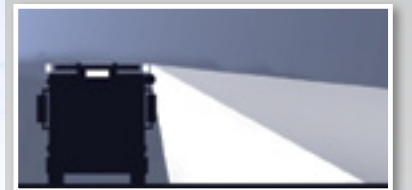
Proyector con Ángulo 15° Hacia Abajo
