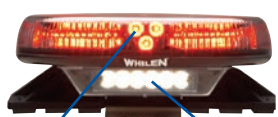
JDLF** dos módulos destellantes de color LR11 en posición de luz de callejón
